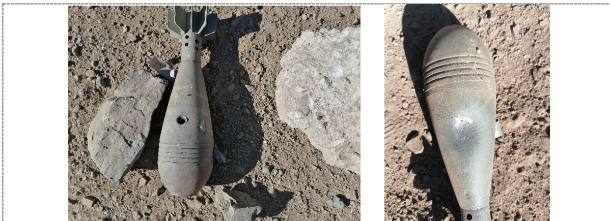
Слика 14. Дејство ЕГП на тело мине 82 mm. Лево експеримент Е10 и десно Е7.
