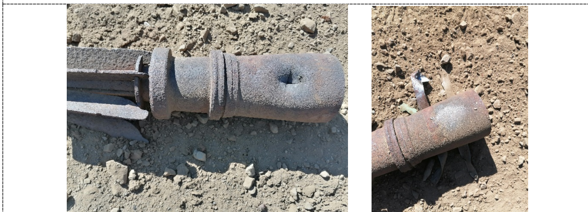
Слика 15. Дејство ЕГП на кошуљицу гранате 100 mm. Лево експеримент Е6 и десно Е5.
