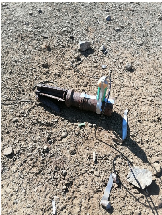
Слика 12. Изглед постављених дистанцера на кошуљицу кумулативне гранате 100 mm и танак челични лим.
