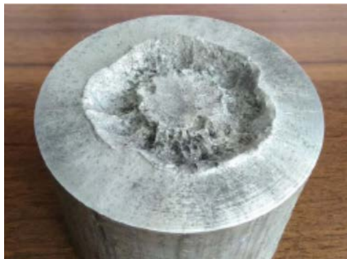
Слика 6. Образац оштећења изазван „мистериозним ефектом“ на алуминијумском контролном блоку, који је резултат експеримента са PMMA цевима [5].
