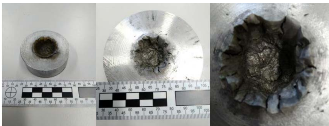
Слика 8. Резултујући обрасци оштећења конусних геометрија. Удубљење у челику (лево), удубљење у алуминијуму и његов детаљ (десно) [5].
