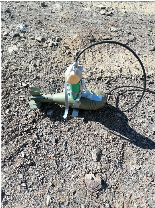
Слика 11. Изглед постављених дистанцера на тело мине 82 mm.
