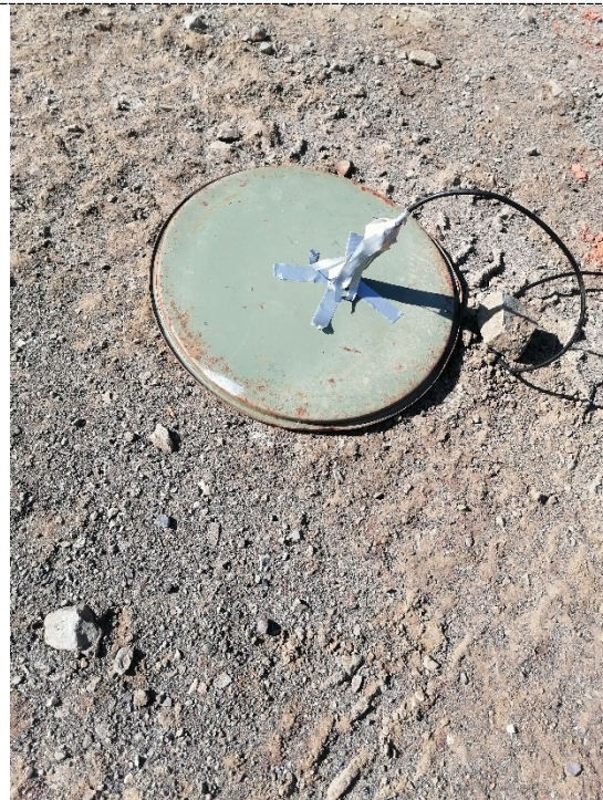
Слика 12. Изглед постављених дистанцера на кошуљицу кумулативне гранате 100 mm и танак челични лим.
