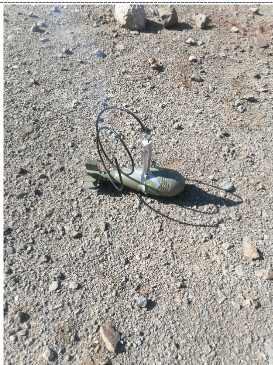
Слика 11. Изглед постављених дистанцера на тело мине 82 mm.
