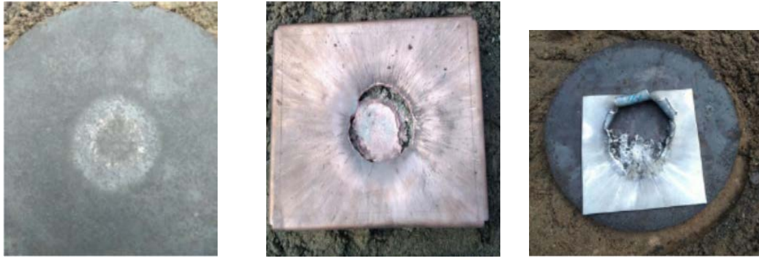
Слика 5. Сlike спроведеног експеримента са различитим плочама и подлогама. Челична контролна плоча (лево), бакарни лим на песку (середина) and алуминијумски лим на челику (десно). [5]
